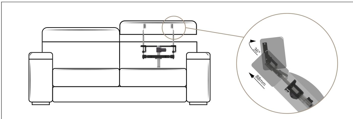
**Benefit:** VERTICAL spin easy motorized è un'evoluzione dell'omonimo poggiatesta VERTICAL motorized. La semplicità d'uso, la compattezza e la tecnologia avanguardistica utilizzata rendono questo prodotto unico nel suo genere. Dotato di un movimento traslante (88mm) che aumenta la superficie
