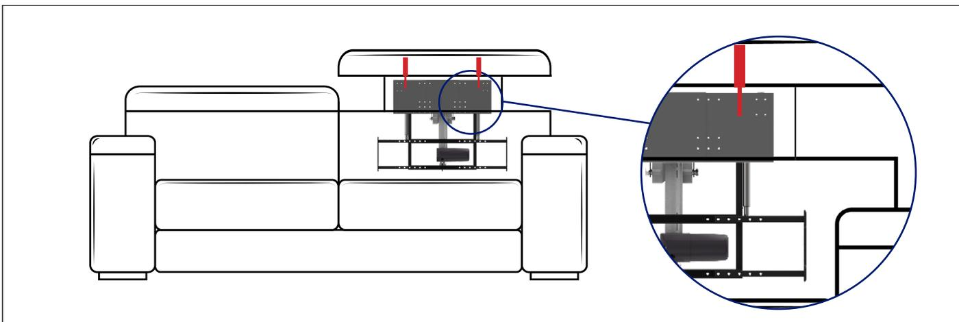
**Benefit:** Il Poggiatesta VERTICAL motorized é un meccanismo motorizzato traslante che consente di regolare l'altezza del poggiatesta a piacimento. Dotato di una tecnologia all'avanguardia, una forma compatta, regolarità e semplicità delle linee e una struttura resistente; queste
