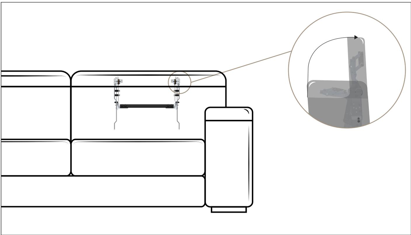
**Benefit:** Poggiatesta manuale completamente foderato all'interno del divano, la struttura estremamente compatta ha le seguenti caratteristiche: rotazione 76°, alzata 135mm, traslazione 91mm. L'alta qualità dei materiali e delle
