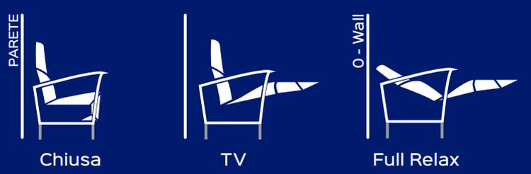
**Benefit:** SPAZIO D.S.C. motorized è la versione compatta (di 40 mm) dell'omonima SPAZIO D.S. Infatti, come nella versione D.S., la D.S.C. (Deep Seat Compact) è caratterizzata da una seduta più profonda (+70mm) che in combinazione al flap, permette ai produttori di imbottiti di poter utilizzare un'unica materassina mantenendo la stessa larghezza tra seduta e pediera. Infine, grazie alla caratteristica Compact,
