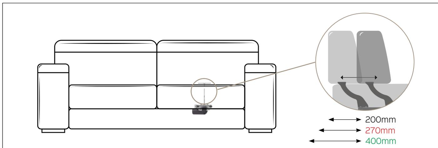
**Benefit:** Supporto schienale elettrico dall'alta efficienza e qualità nell'uso dei materiali e delle componenti elettriche. Il suo movimento lineare permette un'avanzamento dello schienale in diverse configurazioni 200mm, 270mm e 400mm. Le svariate
