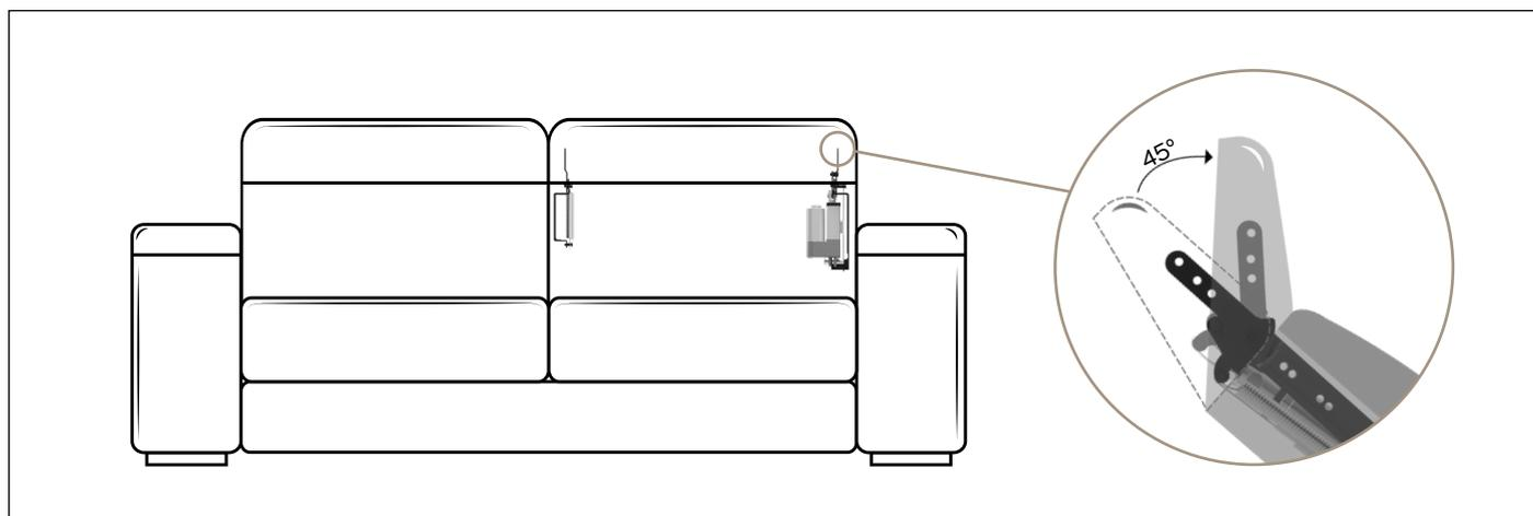
**Benefit:** Il poggiatesta elettrico PUSH HEAD slim presenta una struttura solida, resistente e compatta; si adatta facilmente al design e all'ergonomia del prodotto finito, le leve compiono una rotazione con un angolo di 45° e sono dotate di un meccanismo
