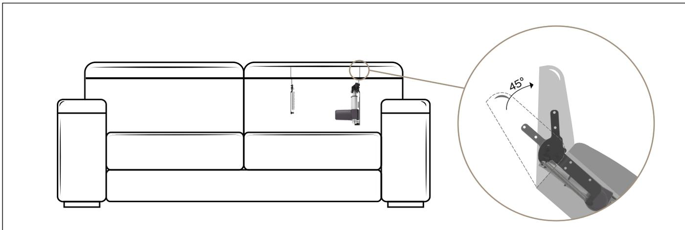
**Benefit:** Il poggiatesta elettrico PUSH HEAD presenta una struttura solida e resistente, si adatta facilmente al design e all'ergonomia del prodotto finito, le leve compiono una rotazione con un angolo di 45° e sono dotate di un meccanismo di ritorno in sicurezza che si blocca se
