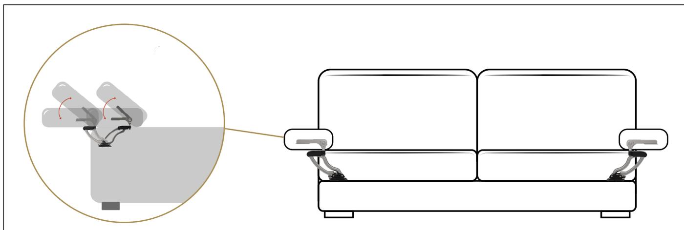
**Benefit:** MITICO evolution + sofà joint manual è un prodotto versatile, adatto a tutte le tipologie di imbottito. Con un semplice movimento, permette di traslare il bracciolo orizzontalmente di 275 mm aumentando il vuoto della seduta.
