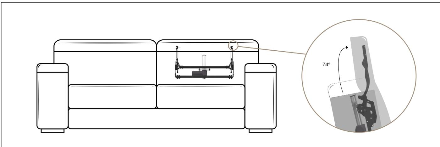
**Benefit:** Poggiatesta elettrico progettato per le sedute fisse. Alta efficienza e qualità nell'uso dei materiali e delle componenti elettriche. Ingombri ridotti e versatilità nell'utilizzo (rotazione di 74°, alzata 170mm, traslazione
