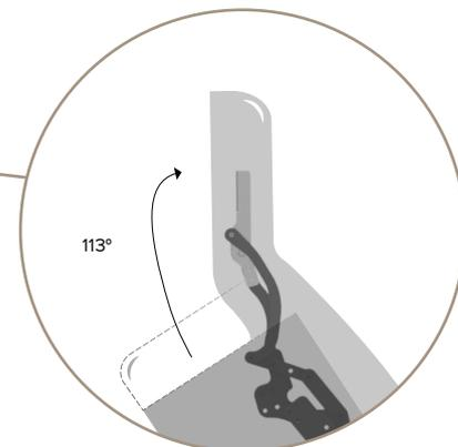
**Benefit:** Alta efficienza e qualità nell'uso dei materiali e delle componenti meccaniche. Ingombri ridotti e versatilità nell'utilizzo (rotazione di 113°, alzata 195mm, traslazione 140mm). Alta efficienza
