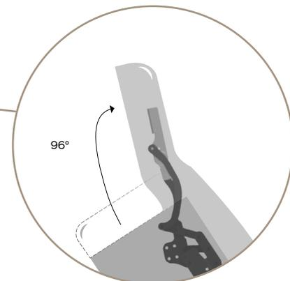
**Benefit:** Alta efficienza e qualità nell'uso dei materiali e delle componenti meccaniche. Ingombri ridotti e versatilità nell'utilizzo (rotazione di 96°, alzata 193mm, traslazione 99mm). Alta efficienza
