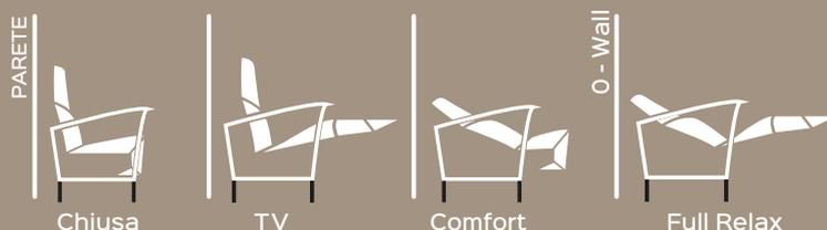
**Benefit:** BRIO two ways è ideale per imbottiti a base aperta e con uno stile più contemporaneo, la presenza di due motori consente di svincolare il funzionamento della pediera da quello dello schienale che si muovono così in maniera indipendente. Azionando gli attuatori si potrà scegliere se reclinare lo schienale, alzare la pediera o far muovere i due
