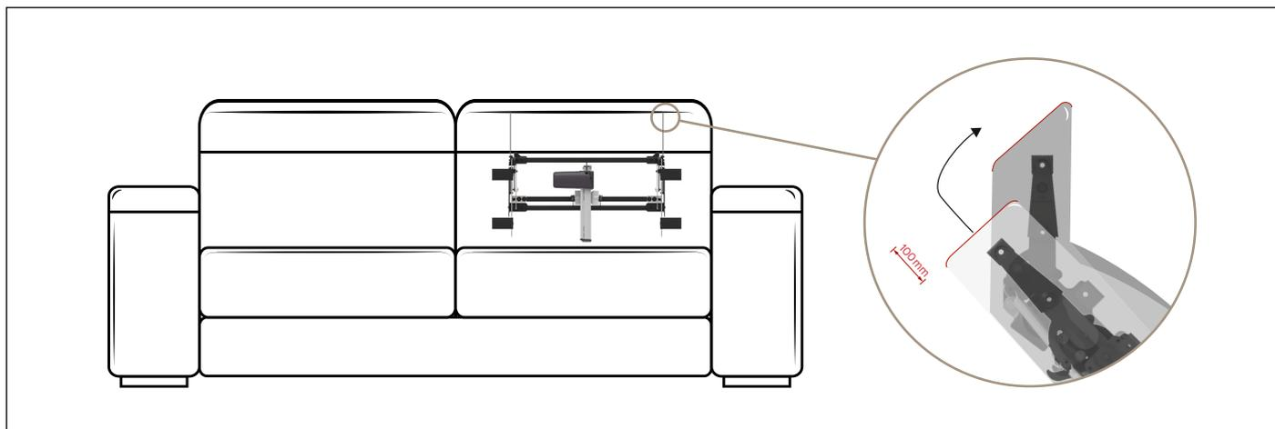
**Benefit:** Il poggiatesta elettrico SPIN UP total back motorized presenta una struttura solida e resistente. La particolarità di questo prodotto è il perfetto connubio tra le caratteristiche di uno schienale e di un poggiatesta che lo rendono unico nel suo genere infatti, una volta fissato sul fusto e messo in funzione, spin up permette un aumento della superficie d'appoggio dello schienale di 100 mm oltre
