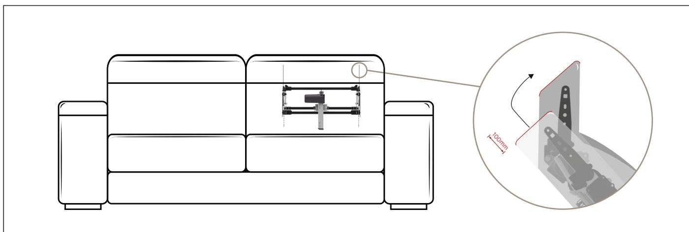
**Benefit:** Il poggiatesta/schienale elettrico SPIN UP presenta una struttura solida e resistente, il meccanismo è stato progettato appositamente per essere inserito anche nei divani con ingombri ridotti al fine di adattarsi all'estetica del prodotto finito. Le leve compiono una traslazione di 100mm e una rotazione con un angolo
