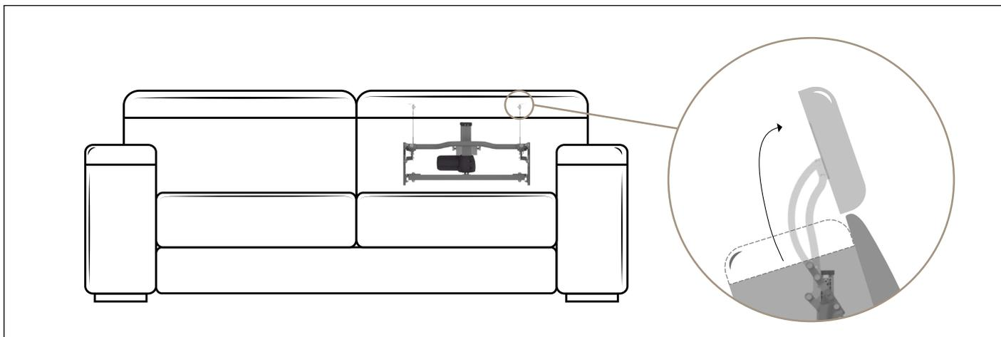
**Benefit:** Il poggiatesta elettrico PLIV26 è un prodotto dal design contemporaneo, efficiente e dagli Ingombri ridotti (compatto) e versatile nell'utilizzo (rotazione di 88°, alzata 215mm, traslazione 76mm) in base al design
